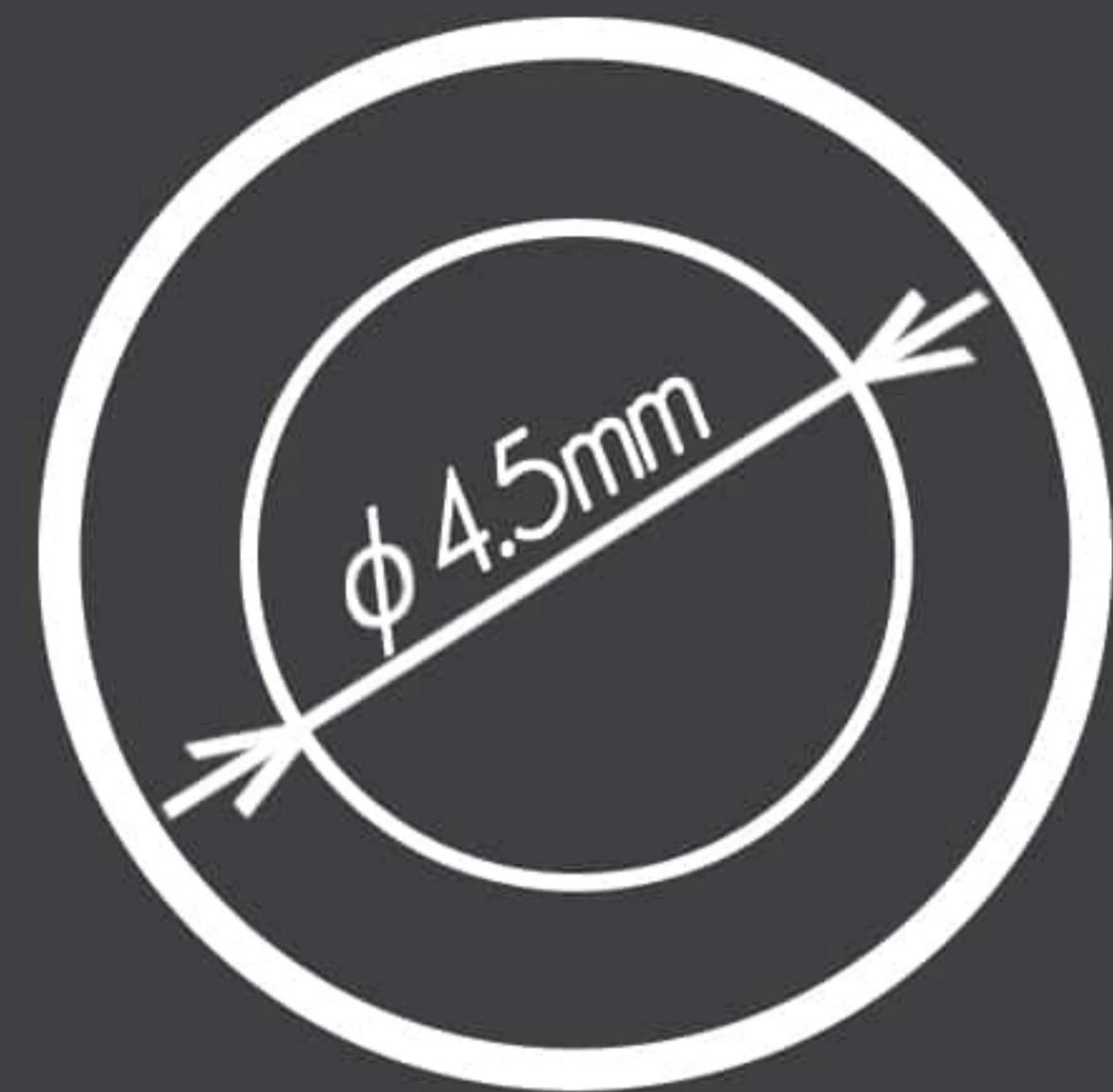
ČELIČNA ŽICA PREČNIKA Ø4,5 MM
